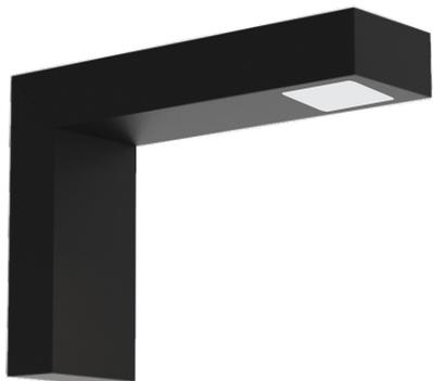
Arandela com perfil retangular, dotada de módulo de LED com 1800 lumens e emissão de luz difusa na cor Branco 2700K. Índice de proteção IP 65 (ambientes indoor e outdoor). Alimentação incorporada com driver on-off bivolt (127V/220V). Disponível em alumínio com pintura eletrostática nas cores Branco, Corten, Grafite e Preto. Consumo de 16W.
