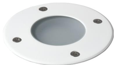
Luminária balizadora com corpo em alumínio, dotada de LED de 100 lumens com emissão difusa. Acabamento frontal em Branco, Corten, Grafite ou Preto (pintura eletrostática) ou aço inox escovado. Alimentação em 12 VCC remota com fonte fornecida separadamente. Índice de proteção IP 67 (uso indoor e outdoor). Alojamento para embutimento em alvenaria ou piso fornecido separadamente. Cores de Led: Branco 2700K, Branco 5000K, Âmbar e Azul. Consumo de 1W.
