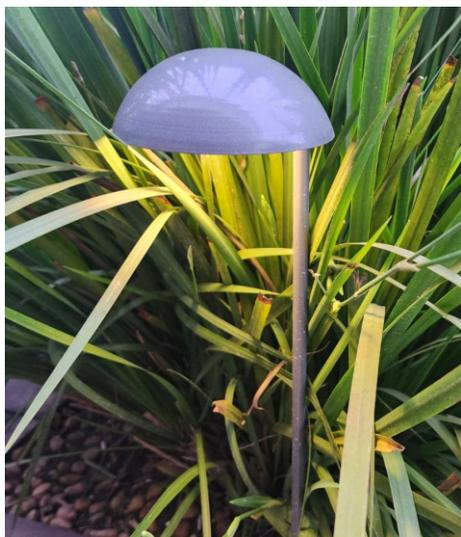
Balizador de jardim para lâmpada de LED (soquete G9), com emissão difusa. Índice de proteção IP 64 (ambientes indoor e outdoor). Disponível em alumínio com pintura eletrostática em Branco, Corten, Grafite ou Preto. Lâmpada fornecida separadamente. Fluxo luminoso, consumo e alimentação conforme o modelo da lâmpada utilizada.
