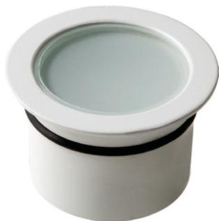
Mini balizador embutido com corpo em alumínio, dotada de LED de 60 lumens com emissão difusa. Acabamento frontal em Branco, Corten, Grafite ou Preto (pintura eletrostática). Alimentação em 12 VCC remota com fonte fornecida separadamente. Índice de proteção IP 67 (uso indoor e outdoor). Alojamento para embutimento em alvenaria ou piso fornecido separadamente. Cores de Led: Branco 2700K, Branco 5000K, Âmbar e Azul. Consumo de 0,5W.
