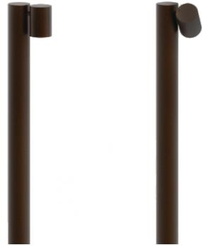
Balizador cilíndrico com iluminador orientável, dotado de LED com 130 lumens, emissão focal com fachos de 15° e 40° e LED na cor Branco 2700K. Índice de proteção IP 64 (uso indoor e outdoor). Alimentação com driver Bivolt (127V/220V) incorporado. Disponível em alumínio com pintura eletrostática em Branco, Corten, Grafite ou Preto. Consumo de 1W.
