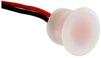
Micro balizador com corpo em poliacetal, dotado de LED de 0,15W com emissão difusa. Indicado para embutir em paredes ou marcenaria. Índice de proteção IP 64 (ambientes indoor e outdoor). Alimentação em 12VCC com fonte de alimentação remota e alojamento para embutimento em alvenaria fornecidos separadamente. Cores de Led: Branco 2700K, Branco 3000K e Âmbar. Consumo total de 0,15 Watts.
