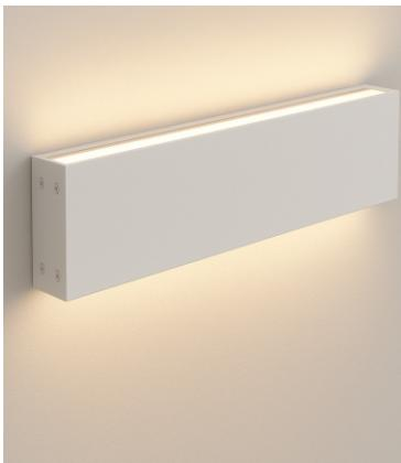
Arandela linear com dupla emissão de luz difusa, com comprimentos de 25 cm, 50 cm, 75 cm e 1 metro, com os respectivos fluxos luminosos de 1250, 2500, 3750 e 5000 lumens. Índice de proteção IP 40 (ambiente indoor). Fabricada em alumínio com acabamento em pintura eletrostática nas cores Branco, Corten, Grafite e Preto. Fonte de alimentação on-off Bivolt (127V/220V) incorporada. Potências de 12W, 24W, 36W e 48W respectivamente.
