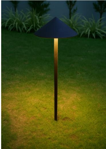
Balizador de jardim com finco para fixação no solo e facho de luz difuso com emissão para baixo. Dotado de módulo de LEDs com potência de 250 lumens, cor de emissão Branco 2700K e alimentação através de fonte blindada bivolt e ON-OFF IP65 (enterrada próxima à luminária). Corpo em alumínio com pintura eletrostática nas cores : Branco, Corten, Grafite ou Preto.
